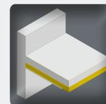
Isolamento di soffitti dall'interno su telaio metallico
