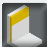
Isolamento di pareti dall'interno ove sia richiesta la presenza di un freno al vapore
