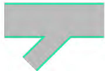
Las desviaciones estáticas se pueden unir al conducto principal con una conexión usando pegamento y cinta adhesiva. Esta conexión es llamada Macho/Hembra para extensiones cortas y livianas, o pueden estar hechas con perfiles, cuando se unen porciones de ductos más grandes, largas o con accesorios pesados (ej. difusores, rejillas o válvulas de control).
