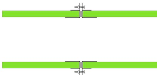
ATENCIÓN, a causa de las vibraciones y de las diferencias térmicas se aconseja el uso de tuercas autobloqueantes o de arandelas dentadas para evitar el destornillarse de las piezas.
