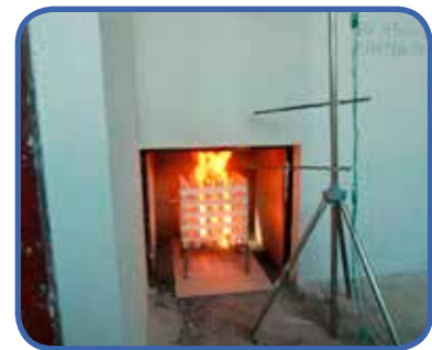
Innesco del carico di incendio costituito da 25 kg di legno capaci di generare 250-300 kW.
