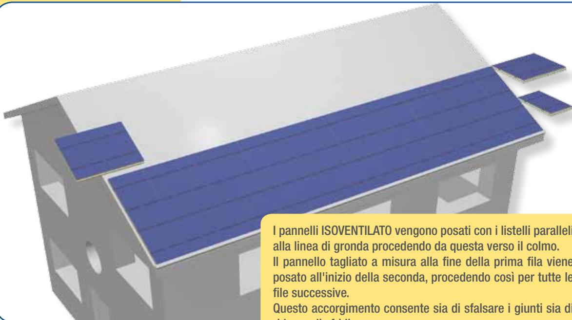
I pannelli ISOVENTILATO vengono posati con i listelli paralleli alla linea di gronda procedendo da questa verso il colmo. Il pannello tagliato a misura alla fine della prima fila viene posato all'inizio della seconda, procedendo così per tutte le file successive. Questo accorgimento consente sia di sfalsare i giunti sia di ridurre gli sfridi.
