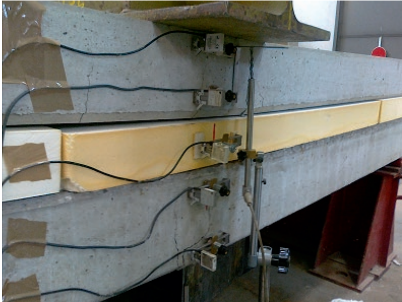
Foto 5. Prova configurazione in semplice appoggio
