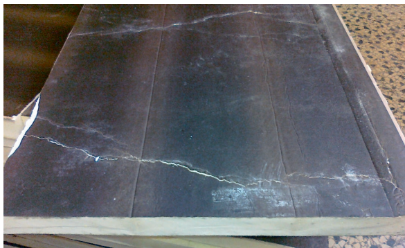
Foto 2. Prova configurazione in appoggio totale
