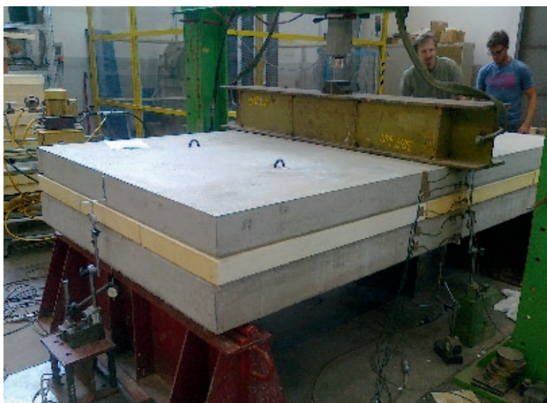
Foto 4. Prova configurazione in semplice appoggio
