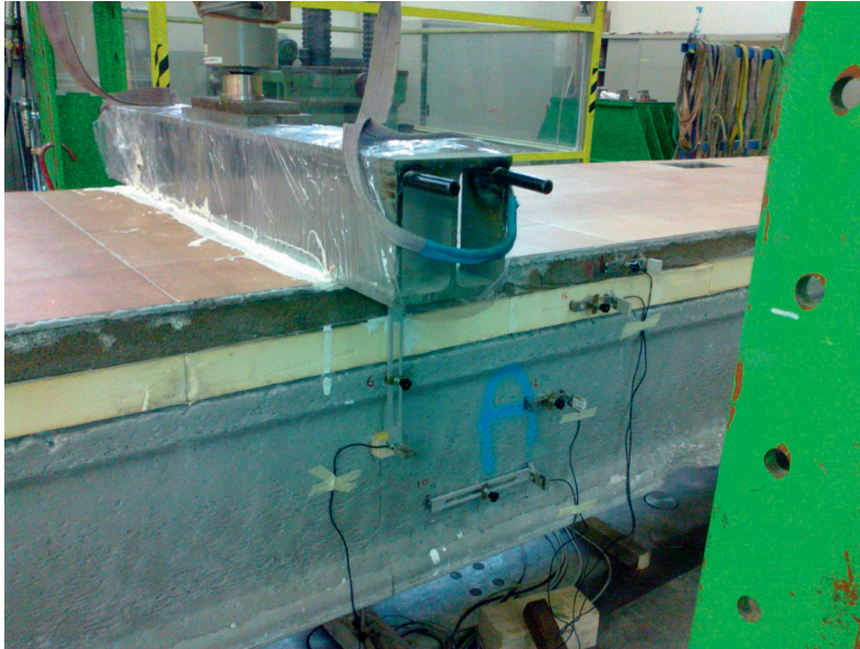
Foto 15. Layout di prova - configurazione solaio alveolare
