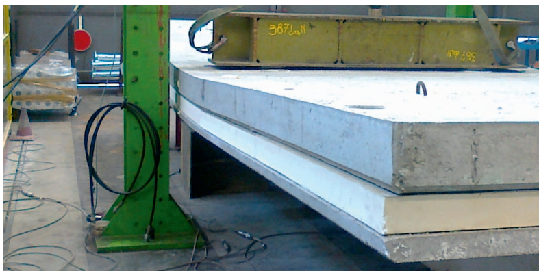
Foto 7. Layout di prova - configurazione solaio π (pi-greco o doppia T in c.a.p.) - copertura industriale prefabbricata
