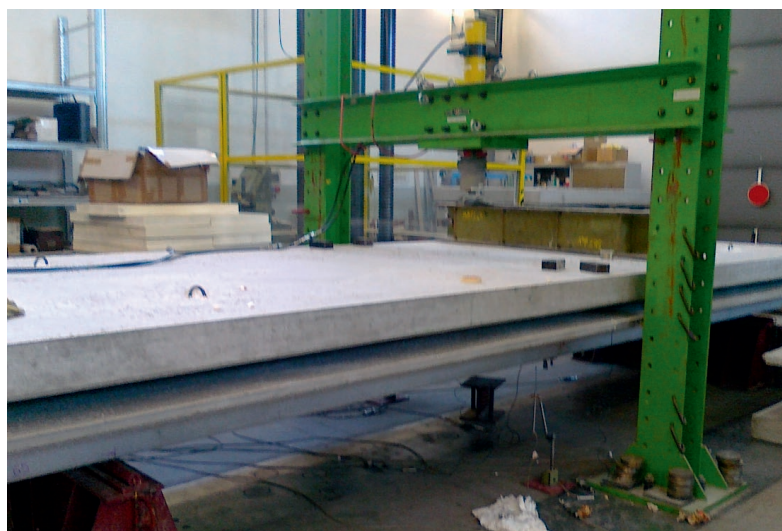
Foto 6. Layout di prova - configurazione solaio π (pi-greco o doppia T in c.a.p.) - copertura industriale prefabbricata
