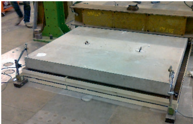
Foto 1. Prova configurazione in appoggio totale
